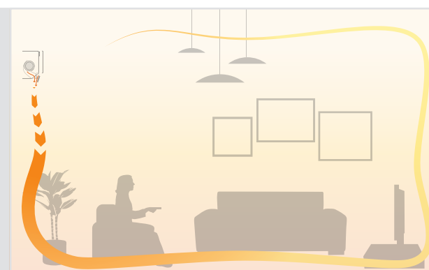
Het Coanda-effect creëert twee verschillende luchtstroompatronen afhankelijk van of koel- of verwarmingsfunctie is geactiveerd. De bovenste afbeeldingen tonen het Coanda-effect in koelmodus (plafondluchtstroom) en de onderste in verwarmingsmodus (verticale luchtstroom).
